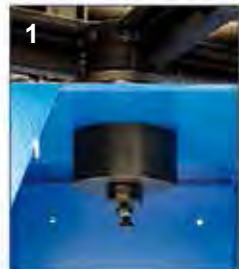
▲ РОЛИКОВАЯ КАТУШКА С МЕХАНИЧЕСКИМ ТОРМОЗОМ
