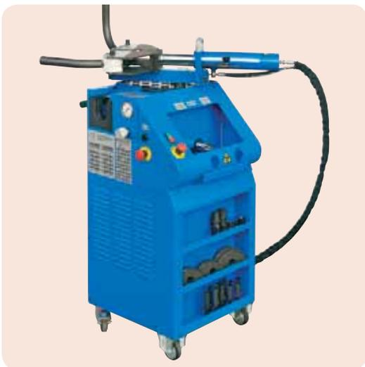
**Center Junior** – это многофункциональное мобильное устройство, позволяющее осуществлять все операции, необходимые для обработки гидравлических труб: резку, внутреннюю и внешнюю зачистку, гибку, монтаж кольца по стандарту DIN 2353, 37° развальцовку труб из нержавеющей (AISI 316Ti) и углеродистой стали (ST 37.4) от 6 до 42 мм с толщиной стенки 4 мм с соблюдением стандартов SAE и JIC. Center Junior оснащен компрессором для внутренней очистки труб.
